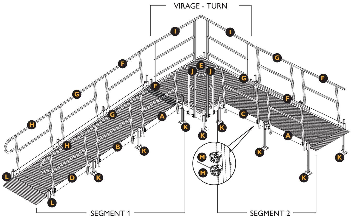
**A** Trottoir de haut des segments 1 et 2 - Upper floor section of segments 1 and 2
